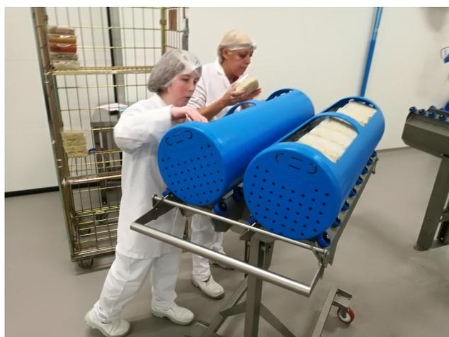
Simple sur le principe. Il « suffit » d'immerger l'aliment (dans son emballage) dans l'eau et de lui faire subir une pression. Celle que les plongeurs connaissent bien : la pression hydrostatique.
